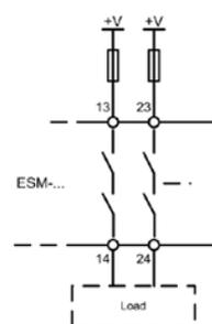
Bild 15: Anschluss zu schaltender Lasten an Sicherheitskontakte (Beispielhafte Kontaktanordnung. Je nach Gerätetyp abweichend. Schaltspannungen +V entsprechend techn. Daten).
