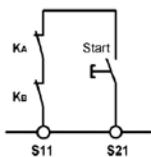
Bild 12: Rückführkreis. Überwachung extern angeschlossener Schütze oder Erweiterungsmodule.
