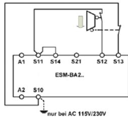
Bild 8: Zweikanalige Schiebeschutzgitter-Überwachung mit Querschchluss- und Masseschluss-Überwachung (Kategorie 4, bis PL e).
