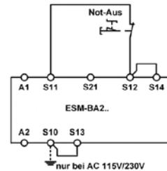
Bild 7: Einkanalige Not-Halt-Schaltung mit Masseschluss-Überwachung (Kategorie 1, bis PL c).
