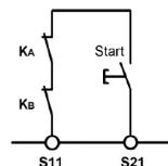
Bild 10: Rückführkreis. Überwachung extern angeschlossener Schütze oder Erweiterungsmodule.
