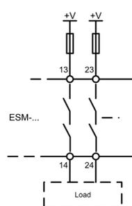
Bild 13: Anschluss zu schaltenden Lasten an Sicherheitskontakten (Beispielhafte Kontaktkonfiguration. Je nach Gerätetyp abweichend. Schaltspannungen +V entsprechend techn. Daten).
