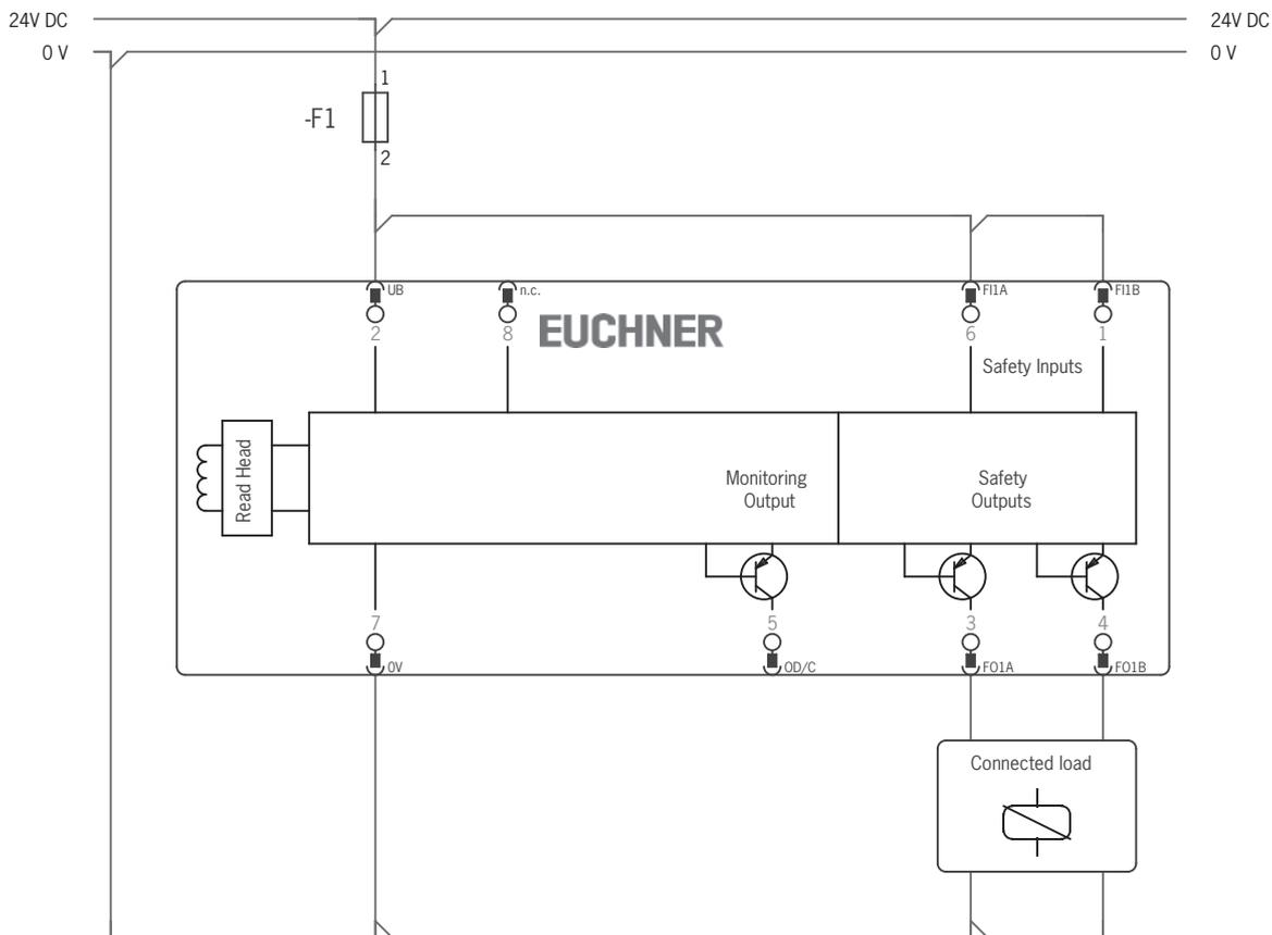
Bild 1: Anschlussbeispiel für Einzelbetrieb eines CES-I-BR-...
