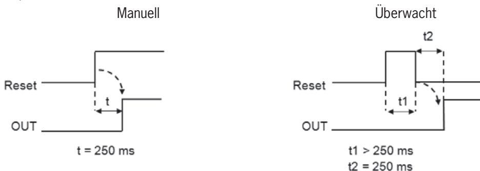
Bild 92: Einkanalige Verriegelung manueller/ überwachter Reset
