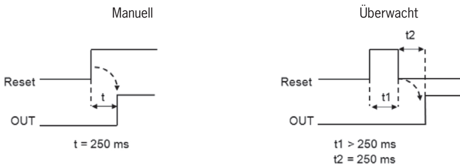
Bild 166: Zuhaltungslogik manueller/ überwachter Reset
