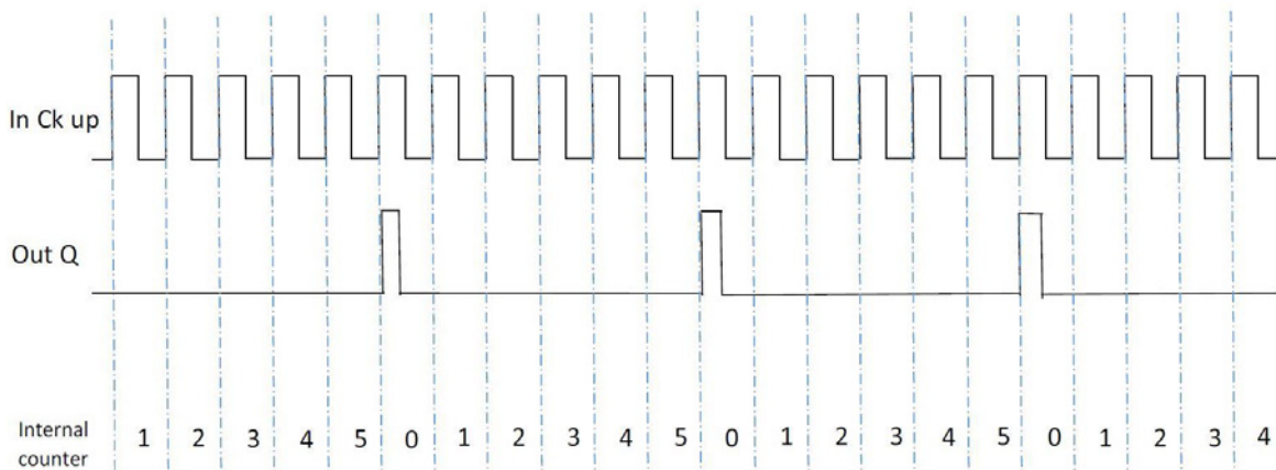
Bild 168: Verwendung des Zählers ohne Rücksetzeingang
