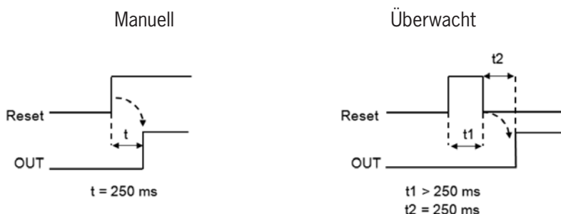
Bild 112: Schaltmatte manueller/ überwachter Reset
