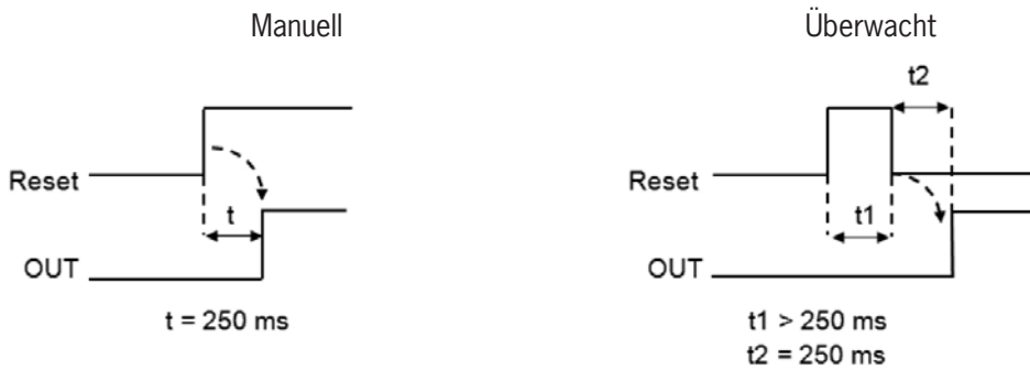
Bild 72: Manueller/ überwachter Reset
