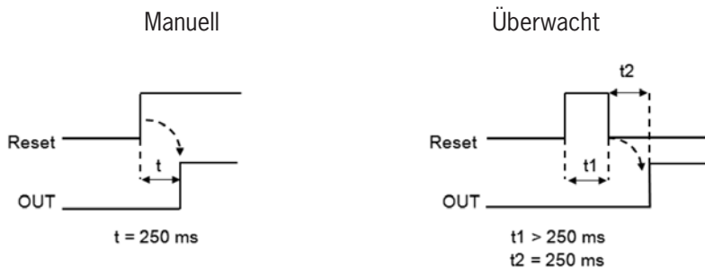
Bild 89: Verriegelung manueller/ überwachter Reset
