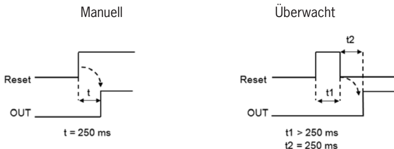
Bild 98: BWS manueller/ überwachter Reset
