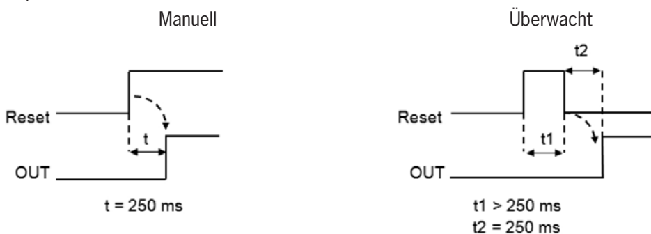
Bild 115: Schalter manueller/ überwachter Reset
