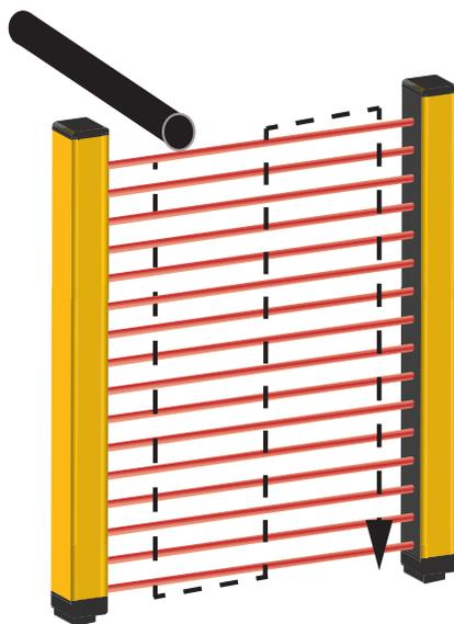
Bild 29: Kontrolle der Schutzfunktion
