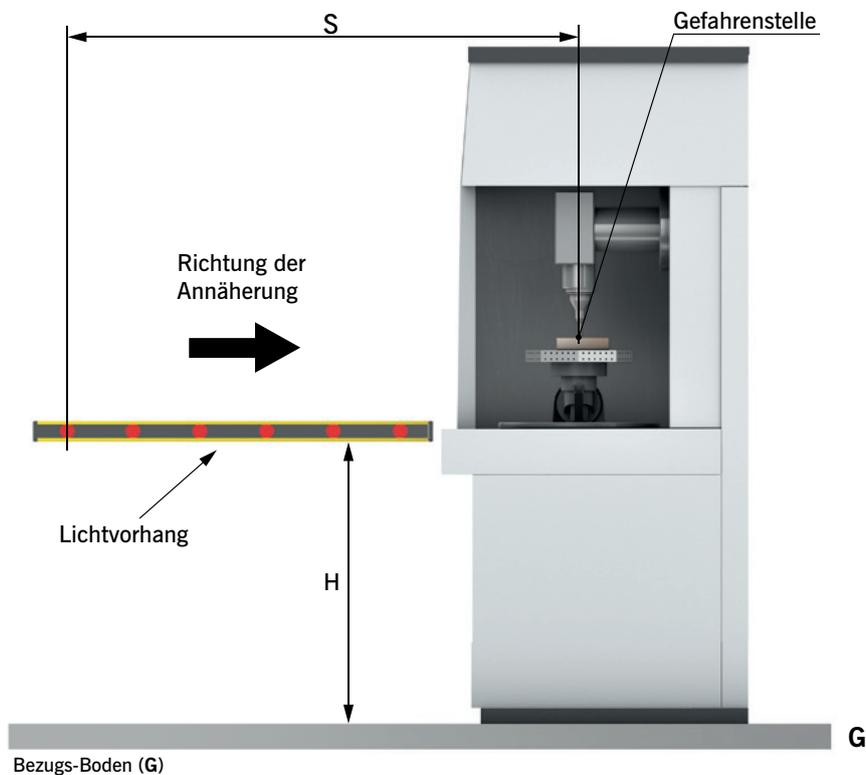
Bild 9: Horizontale Montage für Lichtvorhänge
