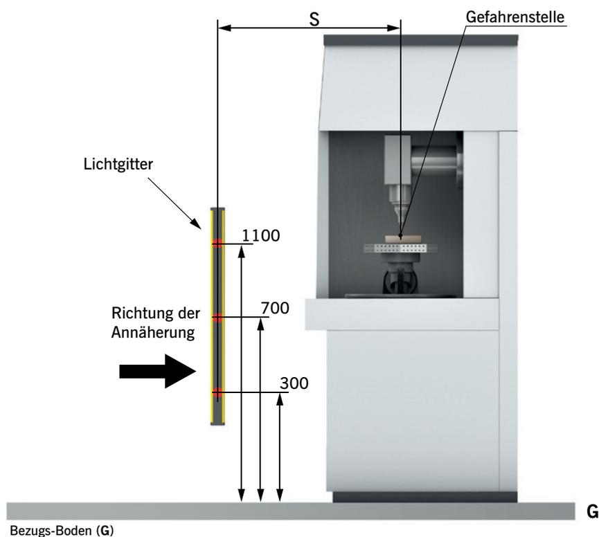
Bild 12: Montage für Lichtgitter
