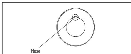
Vor dem Einbau des Typenschilds Nase an dem Typenschild mit einer Zange abbrechen.
