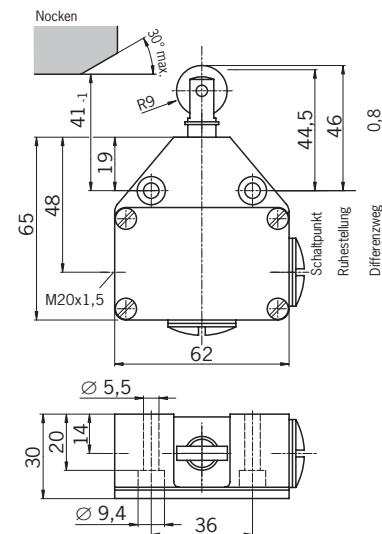
Bild 5: Maßzeichnung N10 mit Rollenstößel lang
