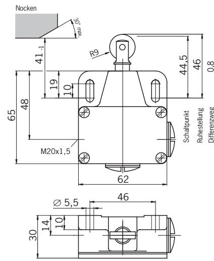
Bild 7: Maßzeichnung N11 mit Rollenstößel lang
