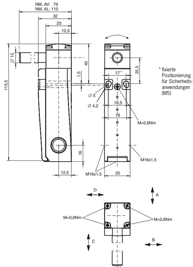
Bild 5: Maßzeichnung NM11AV / NM20AV / NM12AV / NM30AV und NM11AL / NM20AL / NM12AL / NM30AL
