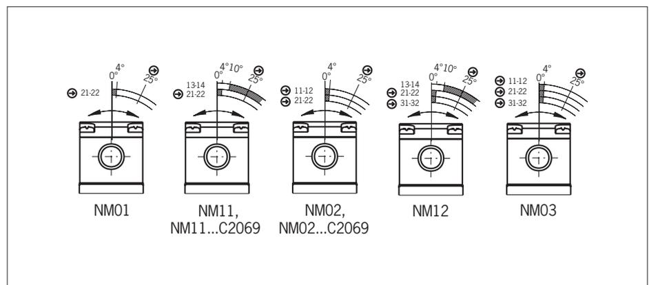
Bild 4: Schaltwegdiagramme NM..AV/NM..AL
