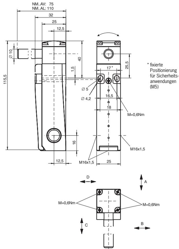
Bild 5: Maßzeichnung NM11AV / NM20AV / NM12AV / NM30AV und NM11AL / NM20AL / NM12AL / NM30AL
