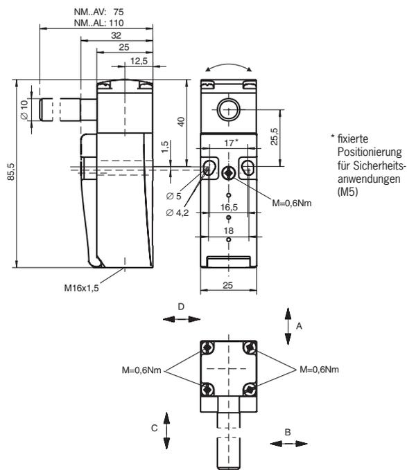
Bild 6: Maßzeichnung NM01AV und NM01AL, NM..AV..C2069 und NM..AL..C2069
