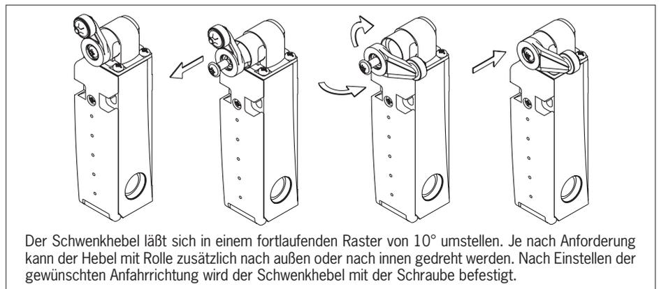
Bild 3: Umstellen des Schwenkhebels
