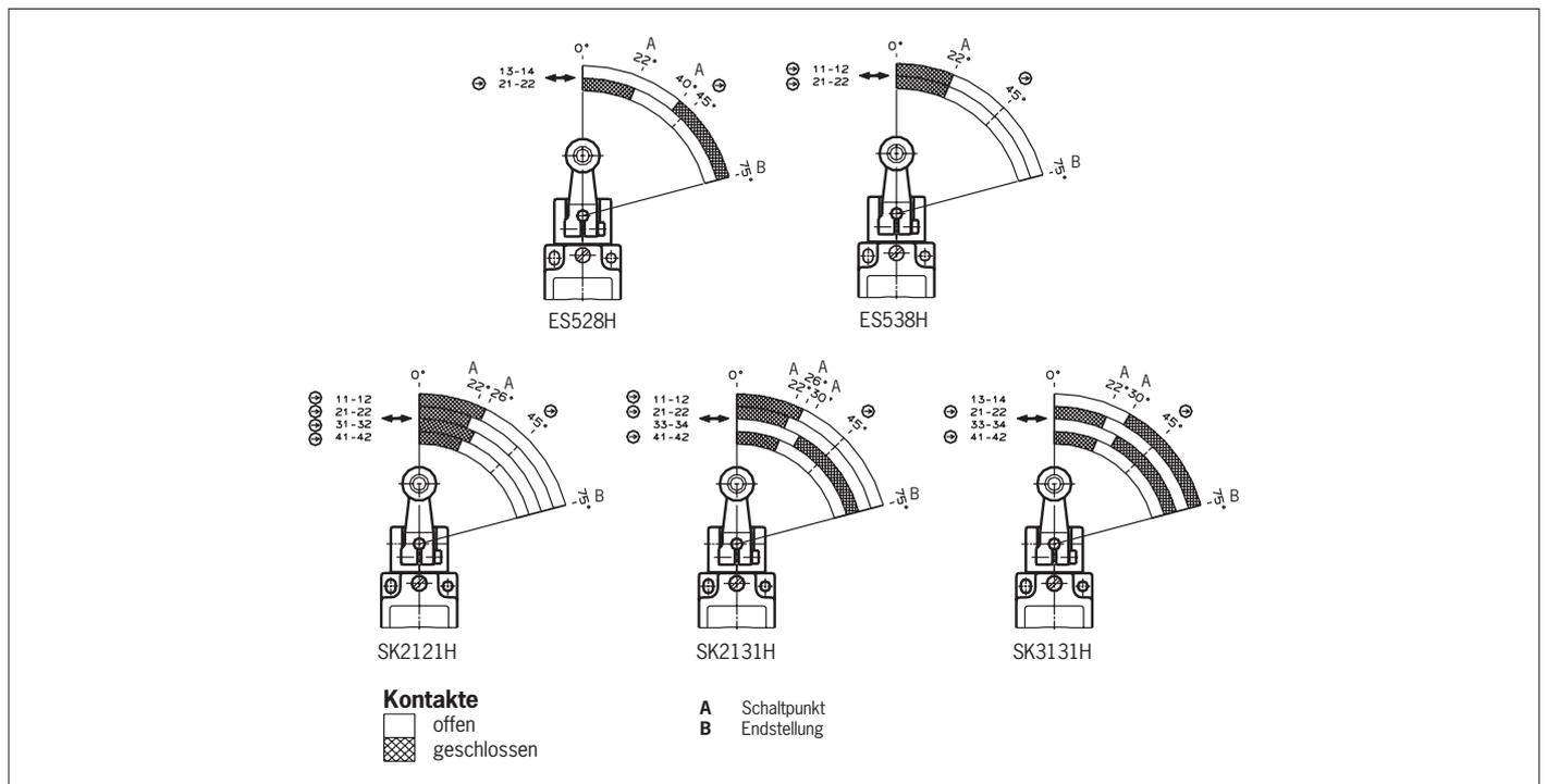
Bild 5: Schaltwegdiagramme
