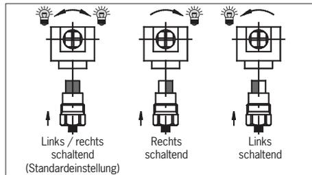
Bild 4: Schaltrichtungsumstellung
