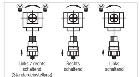
Bild 4: Schaltrichtungsumstellung
