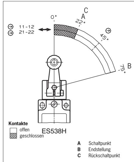
Bild 6: Schaltwegdiagramme
