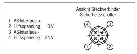
Bild 5: Anschlussbelegung M12-Steckverbinder
