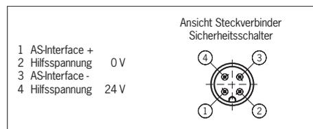
Bild 3: Anschlussbelegung M12-Steckverbinder
