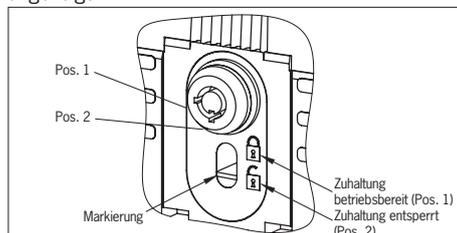
Bild 1: Schlüsselhilfsentriegelung und Anzeige
