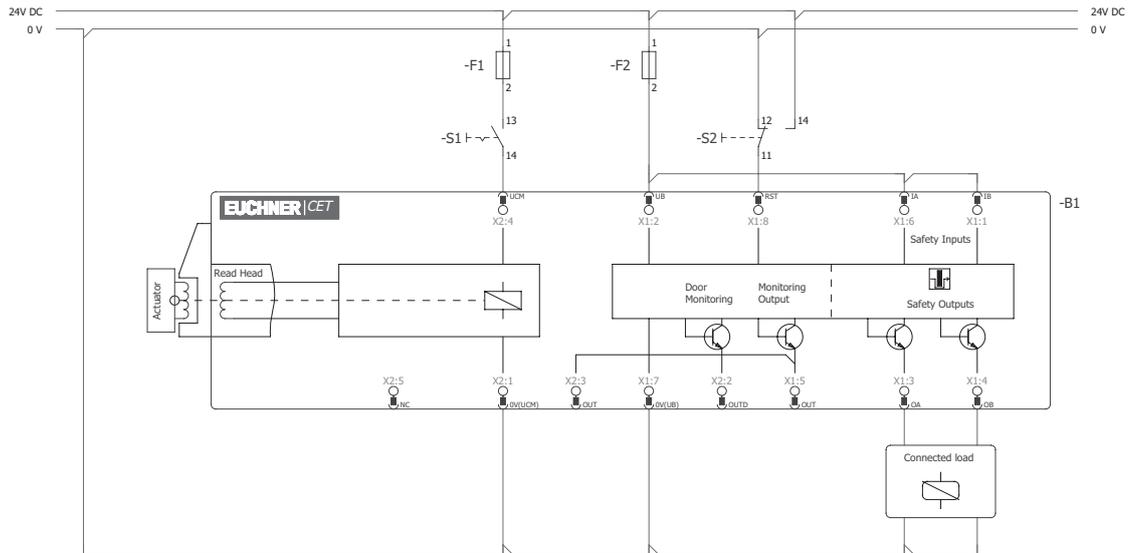
Bild 8: Anschlussplan C, CET 3/4-AR mit Steckverbinder 2 x M12 und zusätzlichem Meldeausgang OUT Einkanalige Ansteuerung des Zuhaltmagneten
