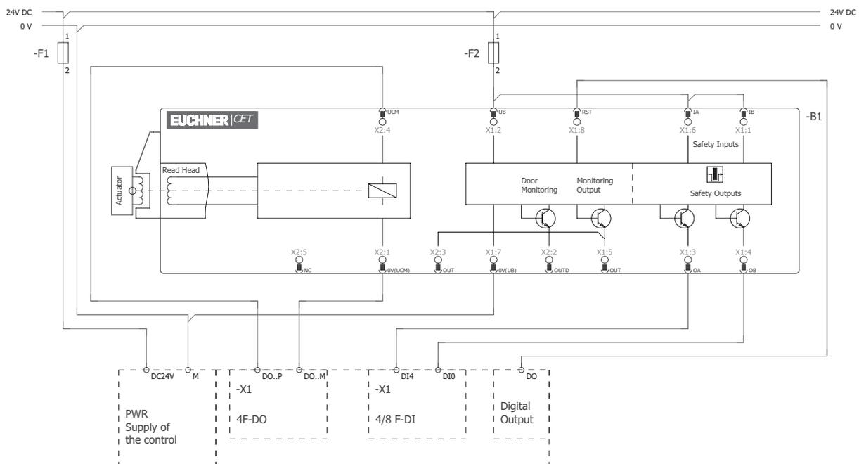
Bild 9: Anschlussplan C, CET 3/4-AR mit Steckverbinder 2 x M12 und zusätzlichem Meldeausgang OUT Zweikanalige Ansteuerung des Zuhaltmagneten
