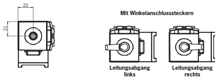
**Ausführung mit Steckverbinder M23 (RC18)**
