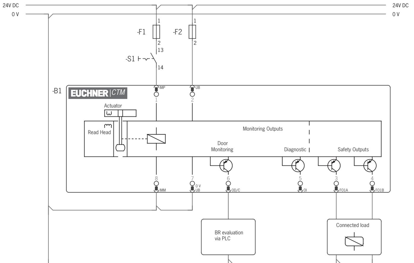
Bild 2: Anschlussbeispiel mit Steuereingang IMM (Prinzipdarstellung)
