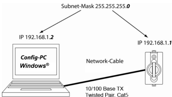
Abbildung 4: Anbindung Konfigurations-PC
