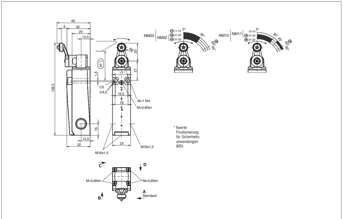
Bild 5: Maßzeichnung und Schaltwegdiagramme NM11HB / NM02HB / NM12HB / NM03HB
