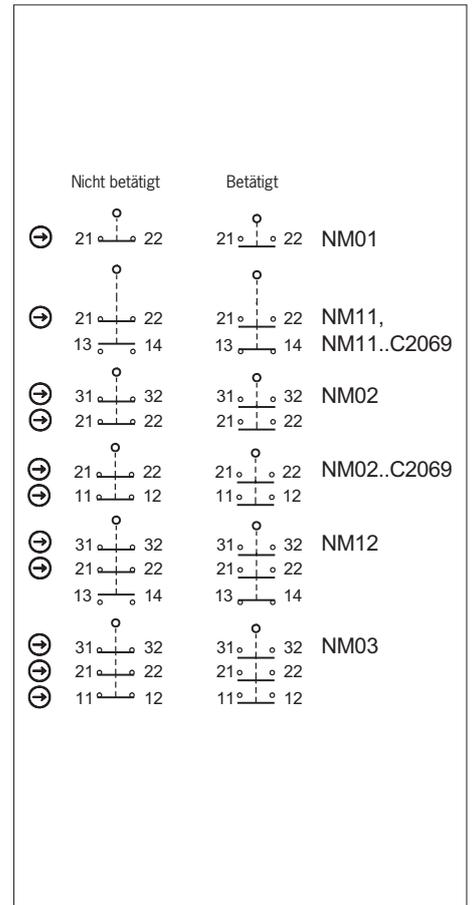
Bild 7: Schaltelemente und Schaltfunktionen
