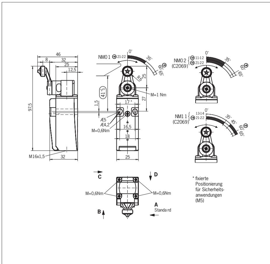
Bild 6: Maßzeichnung und Schaltwegdiagramme NM01HB, NM...C2069
