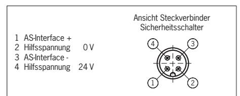
Bild 3: Anschlussbelegung M12-Steckverbinder
