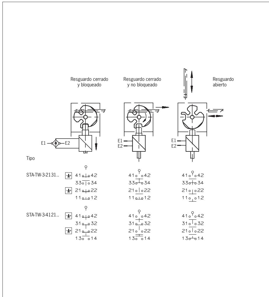
Fig. 3: Elementos interruptores y funciones de conmutación
