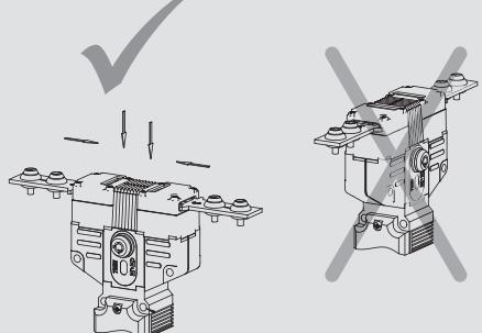
Fig. 2: Cambio de la dirección de accionamiento
