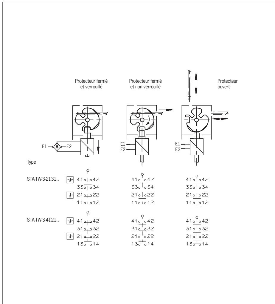
Fig. 3 : Éléments de commutation et fonctions de commutation
