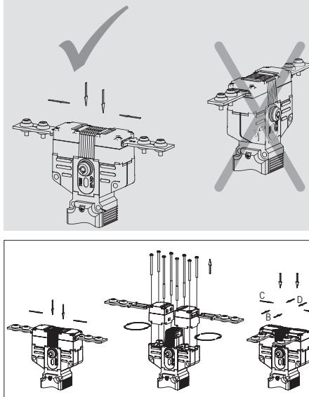
Bild 2: Umstellen der Betätigungsrichtung
