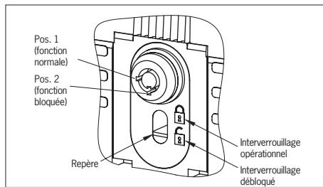
Fig. 1 : Déverrouillage auxiliaire à clé et indicateur
