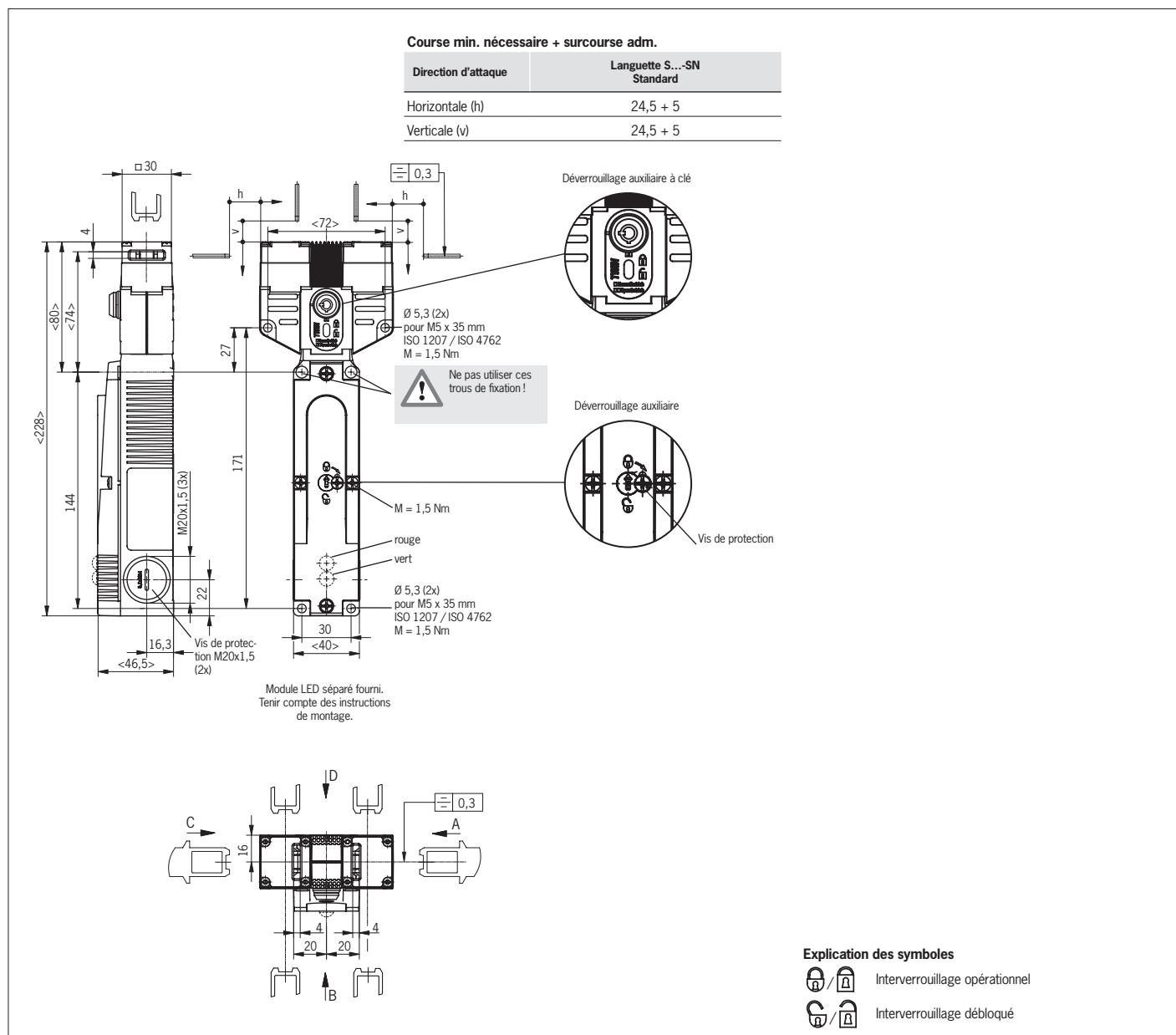
Fig. 5 : Dimensions STA-TW... sans module d'insertion et STA-TW... avec module d'insertion
