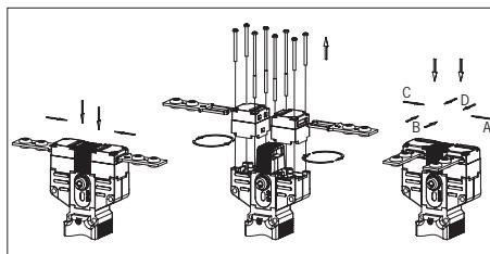
Fig. 2 : Changement de la direction d'actionnement
