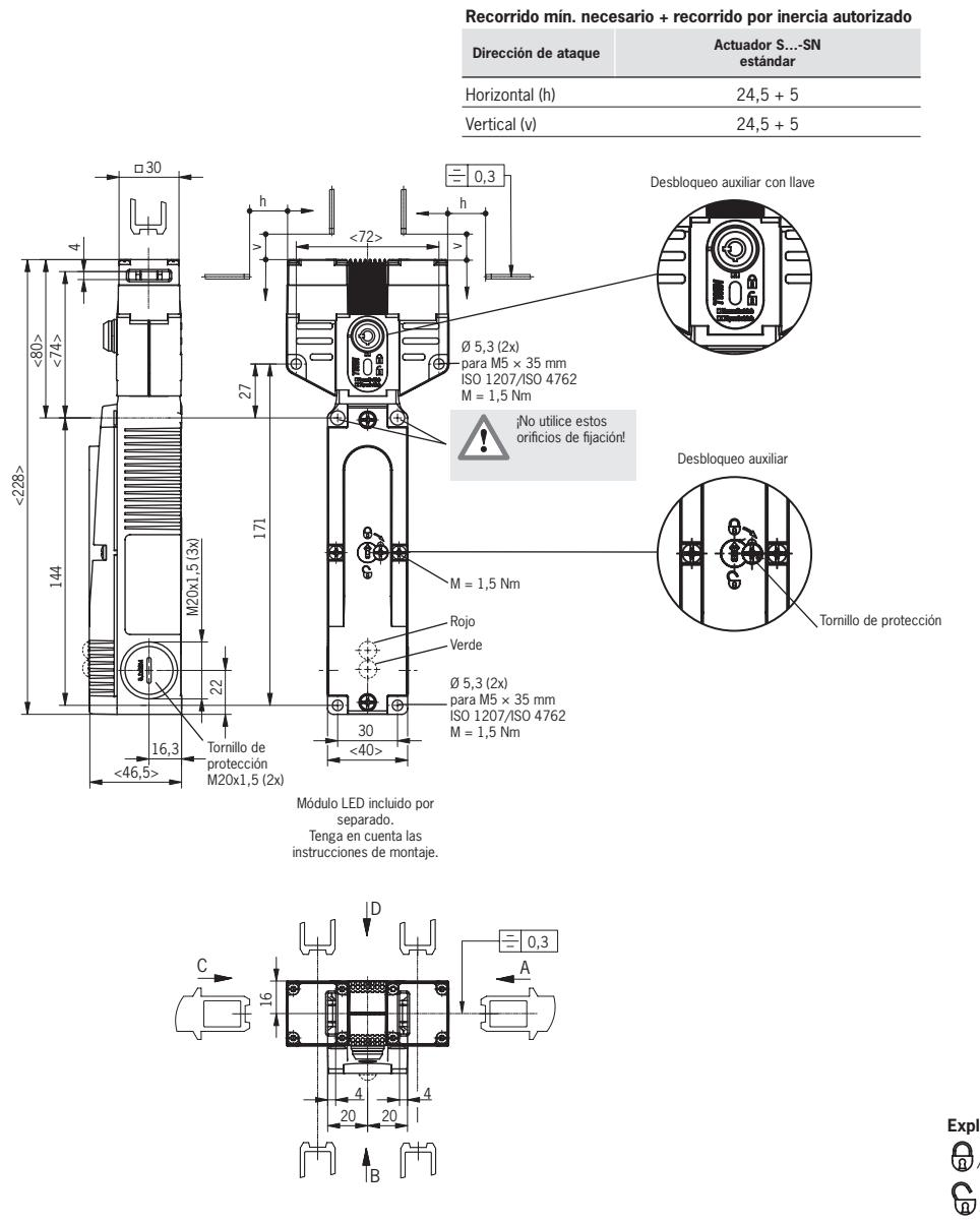
Fig. 5: Plano de dimensiones STA-TW... sin embudo de entrada y STA-TW... con embudo de entrada
