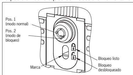
Fig. 1: Desbloqueo auxiliar con llave e indicador
