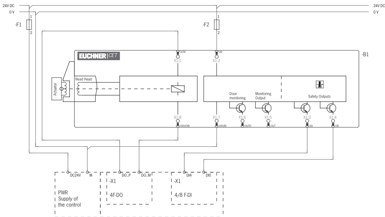
Fig. 8: Esquema de conexiones C/D, CET 3/4-AP con conector 1 x M12, con salida de monitorización de puerta OUT o DIA en X1:5
