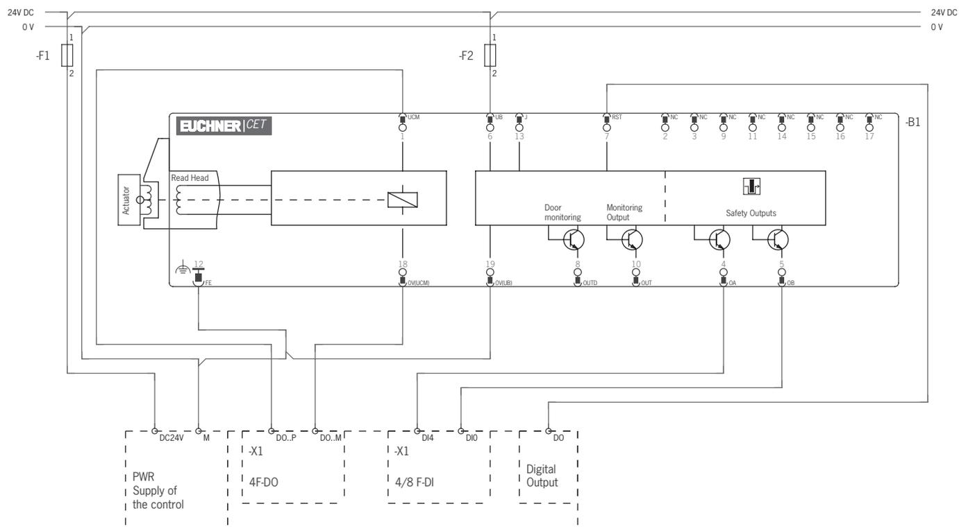
Fig. 10: Esquema de conexiones E, CET 3/4-AP con conector 1 x M23
