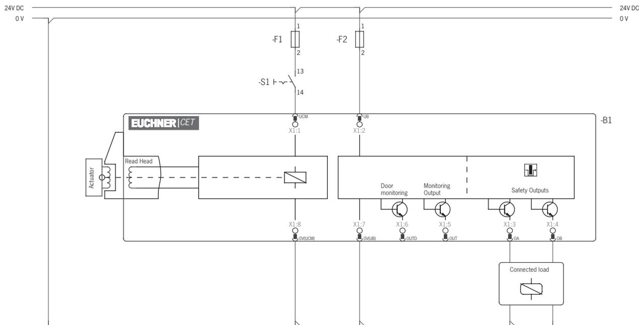
Fig. 7: Esquema de conexiones C/D, CET 3/4-AP con conector 1 x M12, con salida de monitorización de puerta OUT o DIA en X1:5
