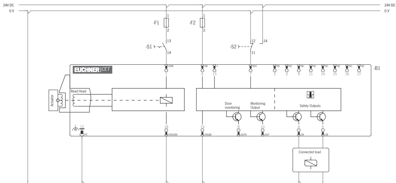
Fig. 9: Esquema de conexiones E, CET 3/4-AP con conector 1 x M23
