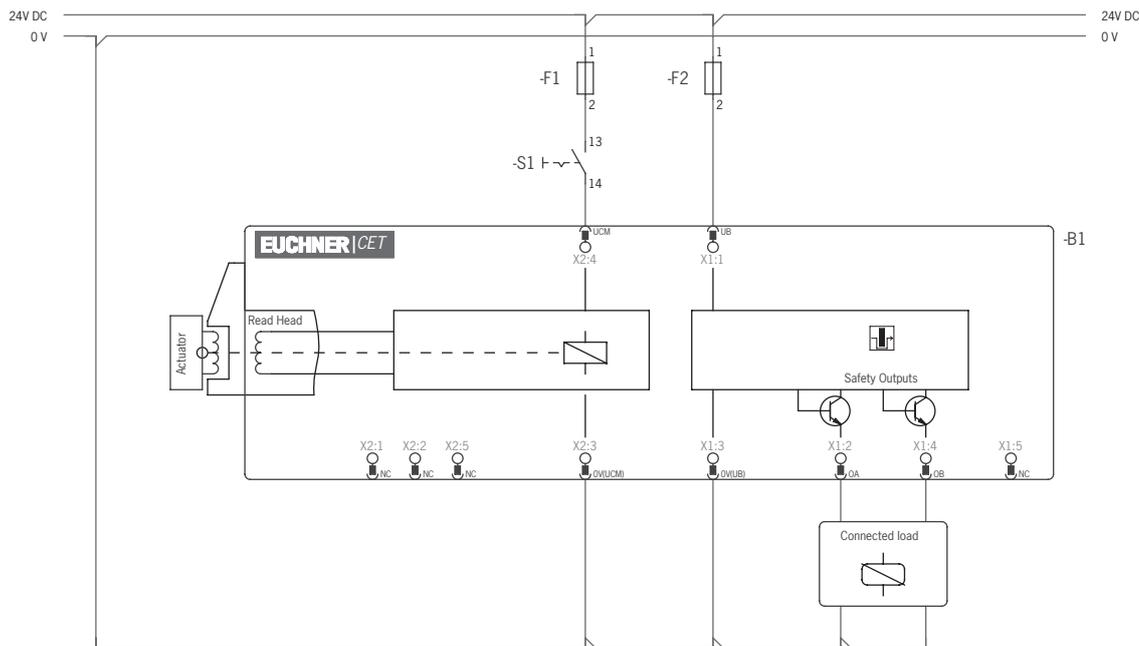
Fig. 3: Esquema de conexiones A, CET 3/4-AP con conector 2 x M12, sin salida de monitorización de puerta
