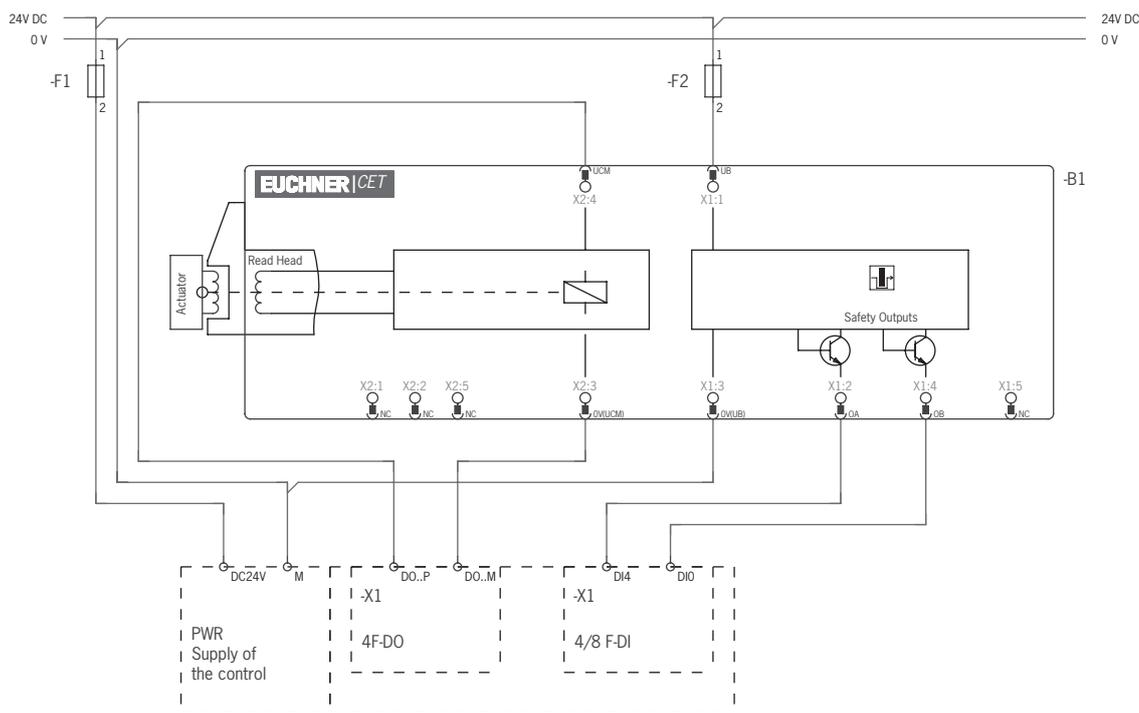
Fig. 4: Esquema de conexiones A, CET 3/4-AP con conector 2 x M12, sin salida de monitorización de puerta
