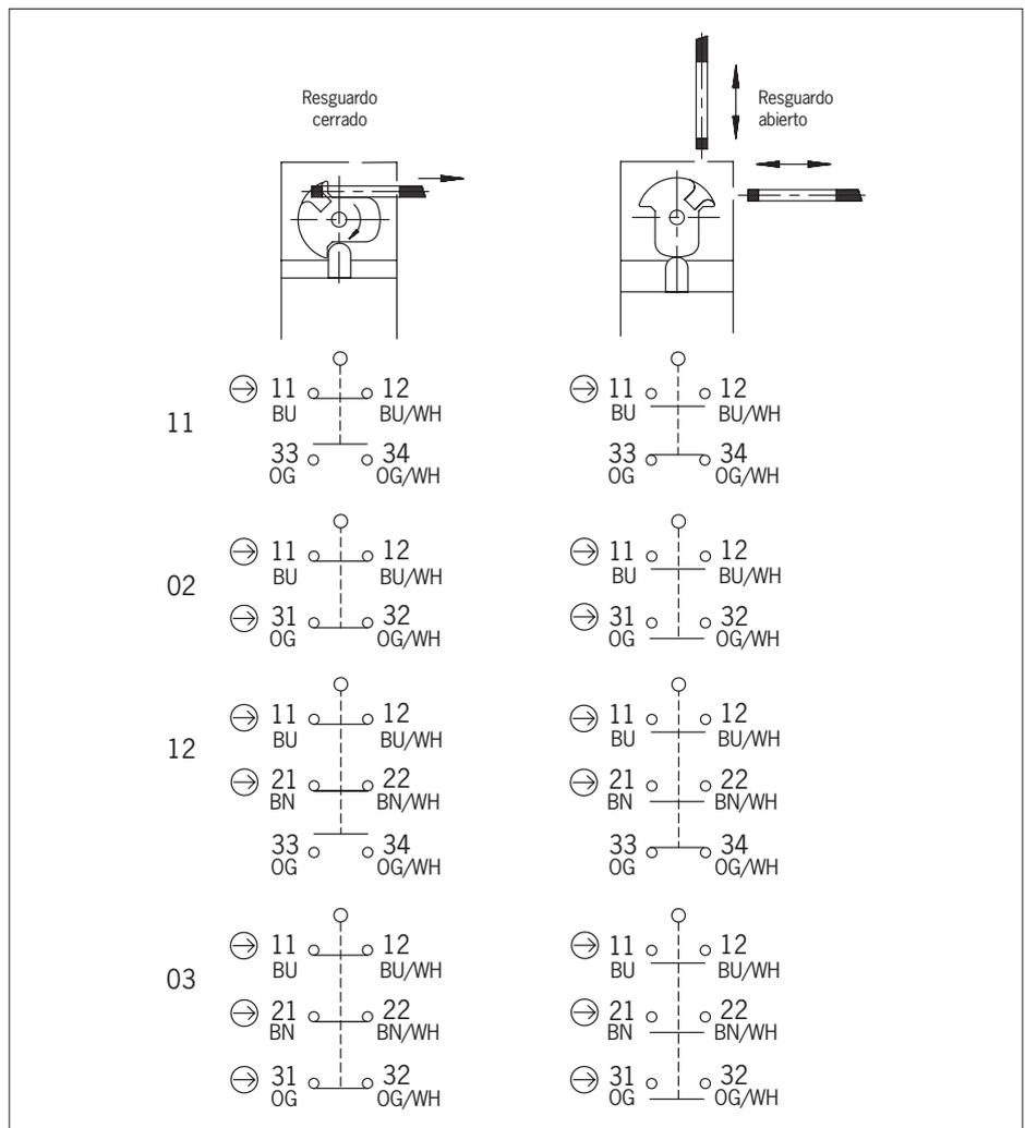
Fig. 1: Elementos interruptores y funciones de conmutación
