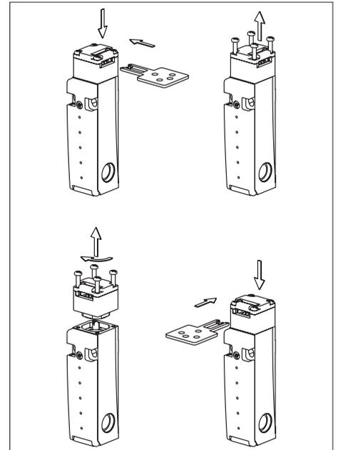
Fig. 1: Cambio de la dirección de accionamiento
