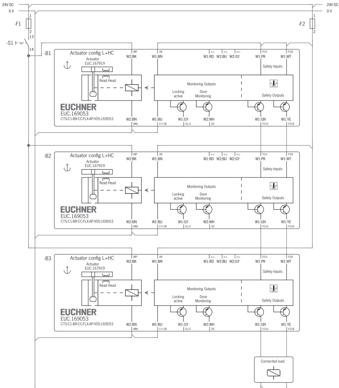
Fig. 6: Ejemplo de conexión en serie (representación gráfica)
