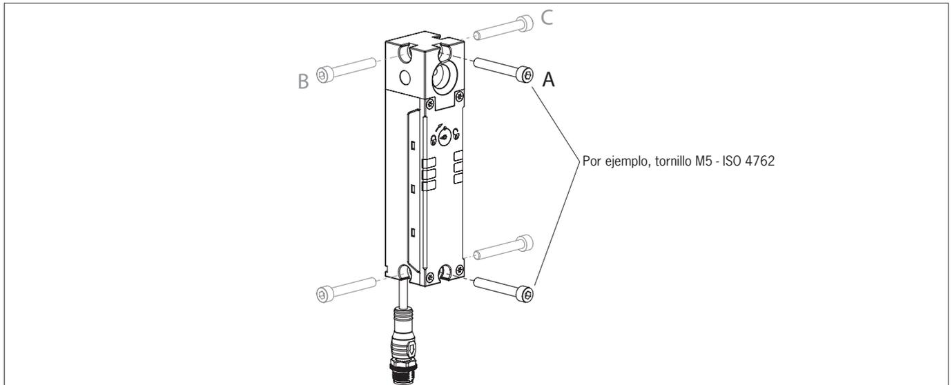
Fig. 1: Montaje frontal (A) y lateral (B, C)
