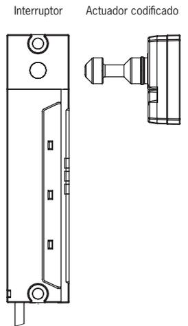
Si se reconoce una codificación autorizada, se activa la señal de posición de la puerta 1 OD. El bloqueo se activa automáticamente si no hay tensión en el solenoide de bloqueo. Las condiciones de conmutación de las salidas de seguridad dependen de la configuración de la monitorización de bloqueo (véase el capítulo 6.4. *Estados de conmutación en la página 12*).
