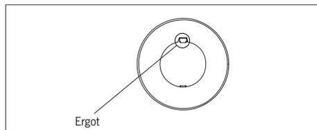
Sectionner l'ergot de la plaque signalétique avec une pince avant de monter celle-ci.
