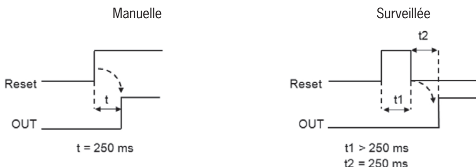
Figure 166 : Réinitialisation manuelle / surveillée de la logique d'interverrouillage
