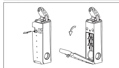
Fig. 2 : Ouverture de l'interrupteur de sécurité
