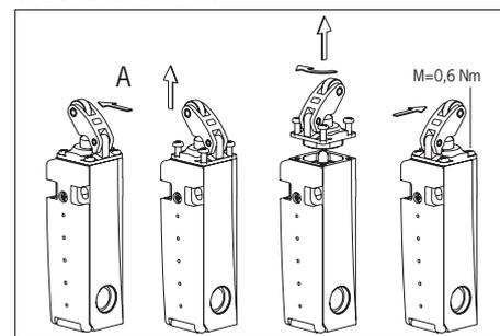
Fig. 1 : Changement de la direction d'actionnement
