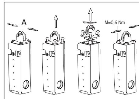
Fig. 1 : Changement de la direction d'actionnement (exemple NM..RB)
