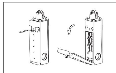
Fig. 2 : Ouverture de l'interrupteur de sécurité (exemple NM..RB)
