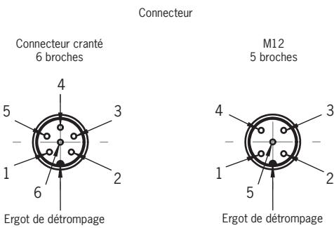
Vue du côté connecteur de l'interrupteur de sécurité
