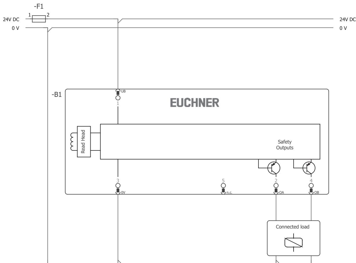
Fig. 2 : Exemple de raccordement CES-AP-...
