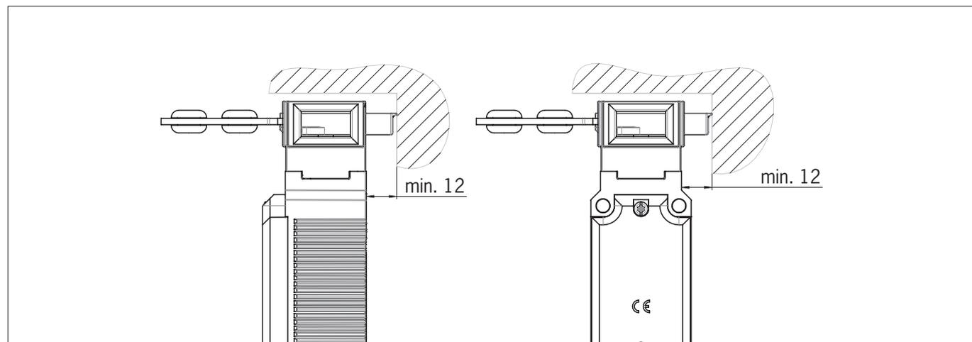
Fig. 2: Spazio libero per la testina dell'azionatore
