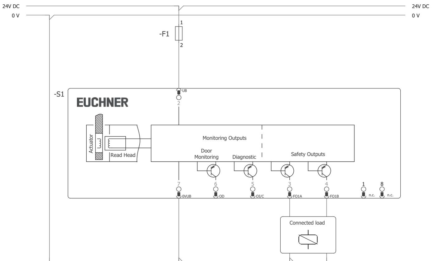
Fig. 3: Esempio di collegamento
