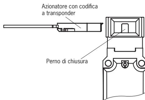
Alla chiusura del riparo, l'azionatore viene inserito nel finecorsa di sicurezza. Al raggiungimento della distanza di commutazione, l'azionatore viene alimentato attraverso il finecorsa dando inizio alla trasmissione dati.
