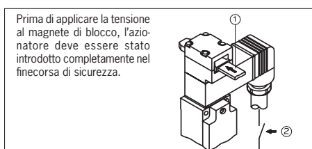
Fig. 5: Fincorsa di sicurezza serie NZ.VZ-...VS.
