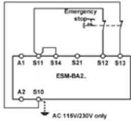
그림 5: 듀얼 채널 비상 정지 회로, 단락 회로 및 접지 오류 모니터링 포함(카테고리 4, PL e까지).
