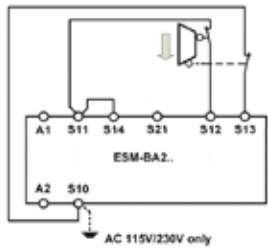
그림 8: 듀얼 채널 슬라이딩 가드 모니터링, 단락 회로 및 접지 오류 모니터링 포함(카테고리 4, PL e까지).
