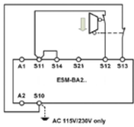
그림 8: 단락 회로 및 접지 고장 모니터링 장치가 장착된 듀얼 채널 슬라이딩 가드 모니터링 장치(범주 4, 최대 PL e).
