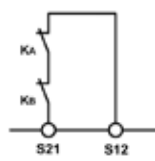
그림 14: 자동 시작 기능이 포함된 피드백 루프. 외부 연결 접점 또는 확장 모듈의 모니터링.
