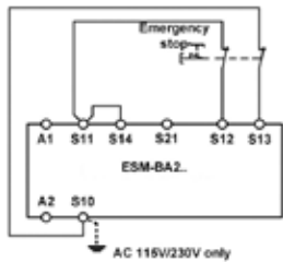
그림 5: 단락 회로 및 접지 고장 모니터링 장치가 장착된 듀얼 채널 비상정지 회로(범주 4, 최대 PL e).
