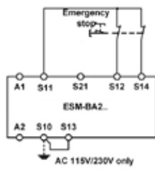
그림 6: 접지 고장 모니터링 장치가 장착된 듀얼 채널 비상정지 회로(범주 3, 최대 PL d).
