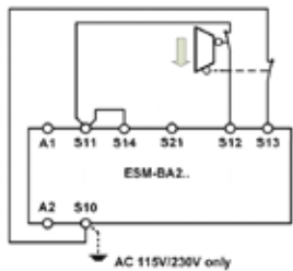
그림 8: 단락 회로 및 접지 고장 모니터링 장치가 장착된 듀얼 채널 슬라이딩 가드 모니터링 장치(범주 4, 최대 PL e).
