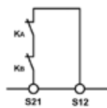
그림 14: 자동 시작 기능이 포함된 피드백 루프. 외부 연결 접점 또는 확장 모듈의 모니터링
