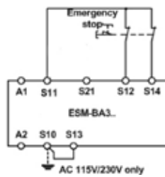
그림 6: 듀얼 채널 비상 정지 회로, 접지 오류 모니터링 포함(카테고리 3, PL d까지).
