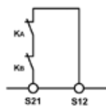
그림 13: 자동 시작 기능이 포함된 피드백 루프. 외부 연결 접점 또는 확장 모듈 모니터링
