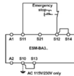
그림 7: 싱글 채널 비상 정지 회로, 접지 오류 모니터링 포함(카테고리 1, PL c까지).
