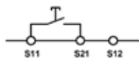
그림 11: 모니터링되는 수동 시작. 비상 정지 버튼을 닫기 전에 시작 버튼이 열렸는지 모니터링됩니다(전제 조건: 작동 전압이 중단되어야 합니다).
