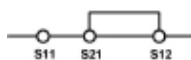
그림 12: 자동 시작. S12 및 S13에서 안전 스위치가 닫히는 동안 최대 허용 지연 시간: S13 이전 S12: 300 ms S12 이전 S13: 임의
