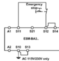
그림 7: 접지 고장 모니터링 장치가 장착된 싱글 채널 비상정지 회로(범주 1, 최대 PL c).
