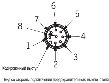
Рис. 2. Схема контактов штекерного соединителя предохранительного выключателя CES-AR-C01
