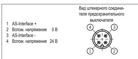
Рис. 2. Схема выводов штекерного соединителя M12
