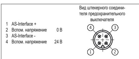
Рис. 2. Схема выводов штекерного соединителя M12
