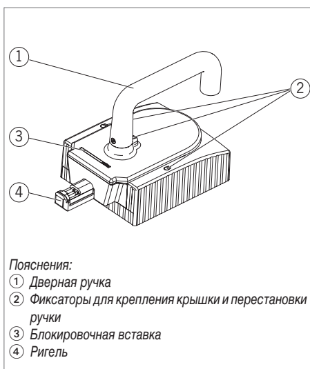
Рис. 2. Модуль ручки MGB-H-...
