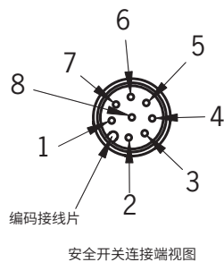
图2: CES-AR-C01安全开关的接头分配
