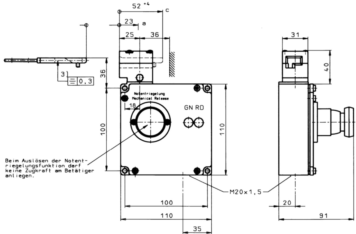
a Leerlaufweg. Betätiger ist im Führungsschlitz, jedoch ohne Funktion auszulösen.
