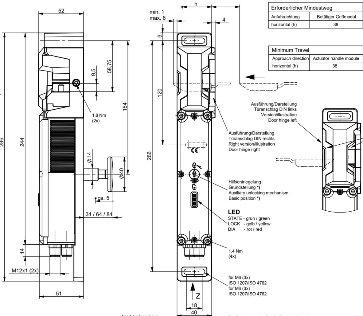
Zur Montage an der Maschine müssen Sicherheitsschalter und Betätiger zusammengefügt sein.
