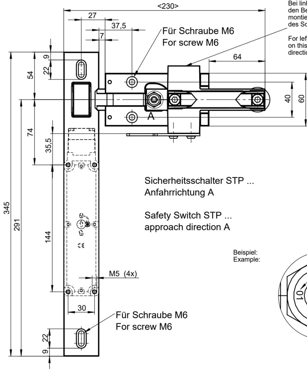
Bei links angeschlagenen Türen den Betätiger auf dieser Seite montieren und die Anfahrrichtung des Schalters und Riegels ändern.
