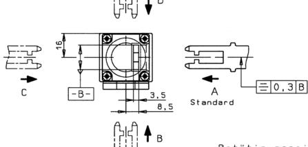
Betätigungsrichtungen Nach Lösen der Befestigungsschrauben kann der Betätigungskopf in die gewünschte Anfahrrichtung umgestellt werden.
