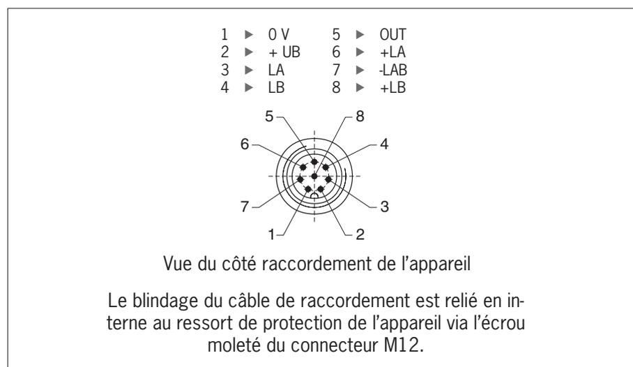
Figure 1 : Affectation des broches interrupteur de sécurité CES-A-.5
