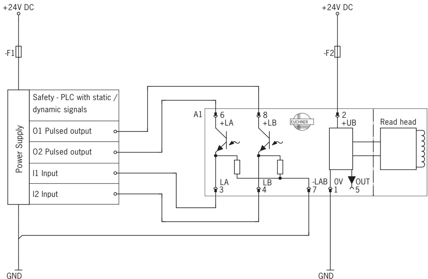
Figure 2 : Exemple de raccordement CES-A-.5
