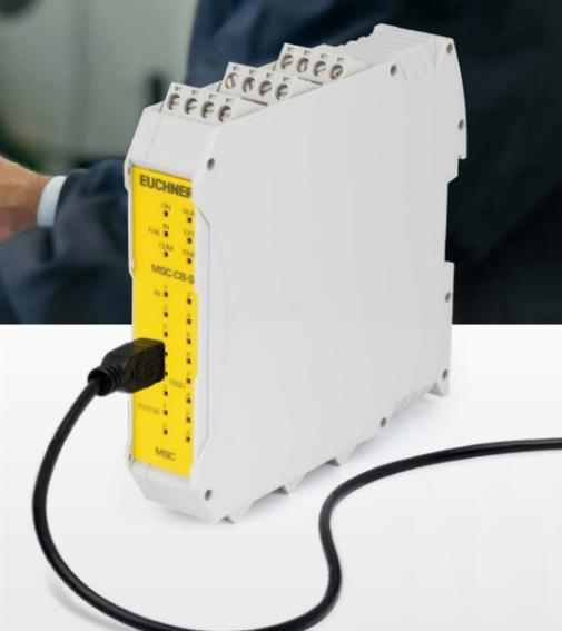
Die Software „EUCHNER Safety Designer“ ermöglicht die Konfiguration, Programmierung und Dokumentation des MSC-Sicherheitssystems. Von der einfachen Bedienung der grafischen Oberfläche über Diagnosemöglichkeiten bis hin zur Erstellung eines Projektberichtes unterstützt die Software eine schnelle Inbetriebnahme.
