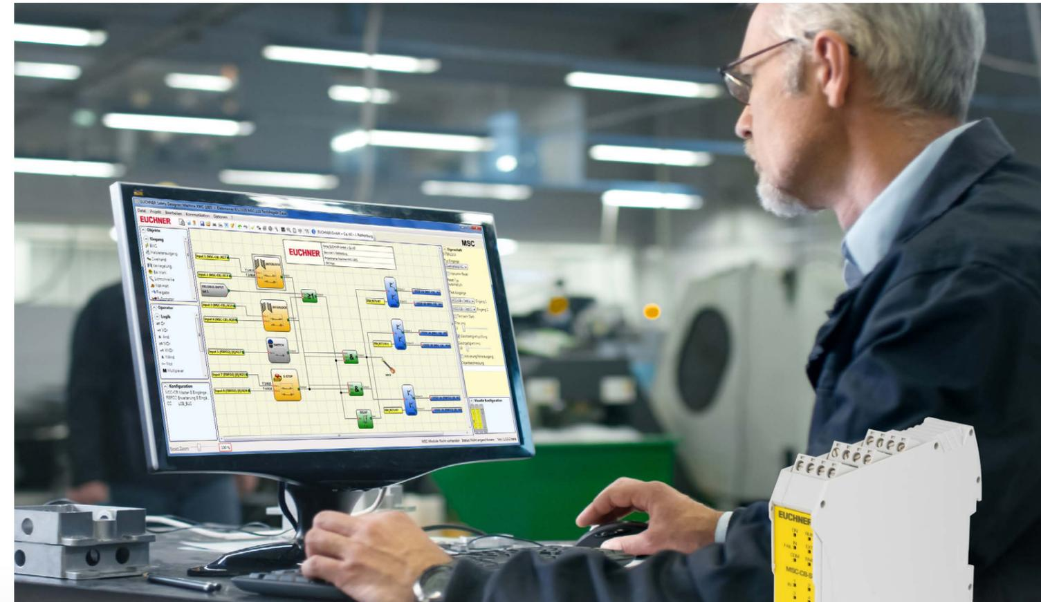
EUCHNER Safety Designer permite la configuración, programación y documentación detallada del sistema MSC. Desde el manejo sencillo de la interfaz gráfica hasta la creación de un informe del proyecto, pasando por las posibilidades de diagnóstico, este software permite una puesta en marcha rápida.
