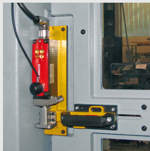
Zabezpieczenie jednych drzwi obrotowych
